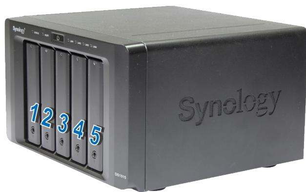
**Примечание:** При необходимости создать том RAID рекомендуется, чтобы все установленные жесткие диски были одного размера для максимального использования дискового пространства.
