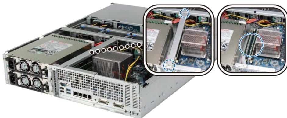
**Внимание!** При снятии крышки будут открыты возможным повреждениям чувствительные внутренние компоненты. Не касайтесь других компонентов при добавлении и удалении модулей памяти.
