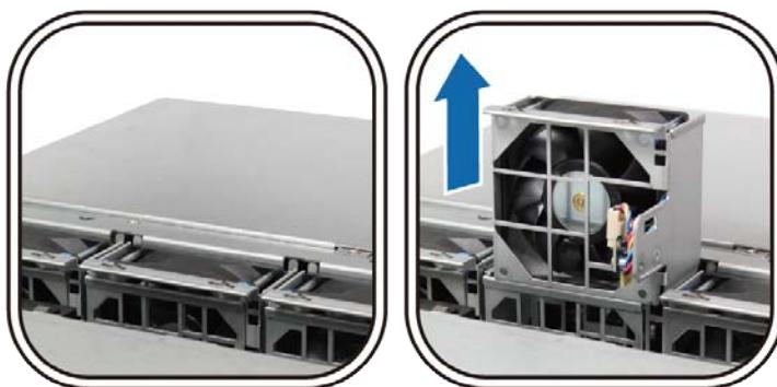
**5** Потяните разъем питания и извлеките его из порта питания, как показано ниже. Извлеките неисправный вентилятор из корпуса.
