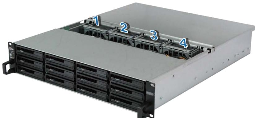
**4** Найдите неисправный вентилятор и приподнимите его для извлечения.
