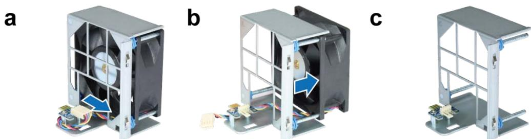
**6** Установите в корпус новый вентилятор. Затем подключите кабель питания к порту питания.
