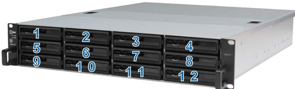
**Примечание.** Для создания раздела RAID рекомендуется использовать жесткие диски одного размера, чтобы оптимизировать использование объема жестких дисков.
